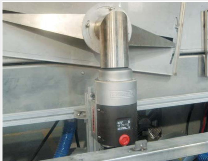
Ein Luftherzer LHS PREMIUM 60S mit Breitschlitzdüse in der Testanlage von „LEBAL“.
