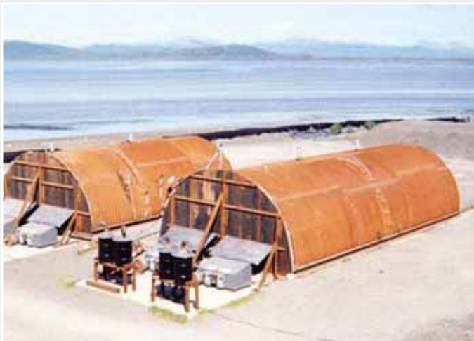
Los sistemas de Desorción Evaporativa están en operación; éstos están situados en la Bahía Togiak, en Alaska.
