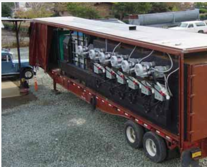
Das System zur thermischen Behandlung von kontaminiertem Boden.
