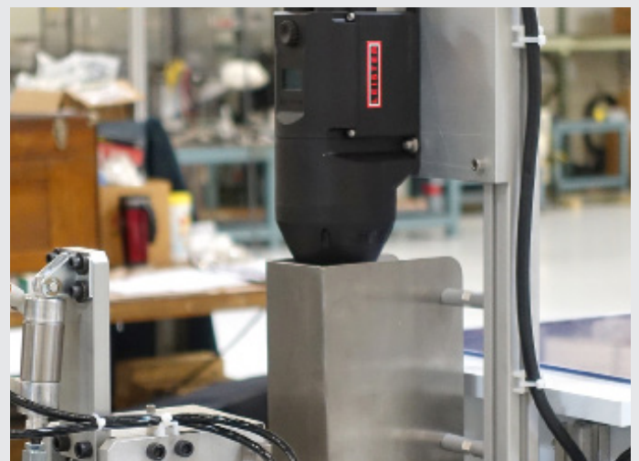
Leister MISTRAL Gebläse installiert in einer Produktionsstrasse.
