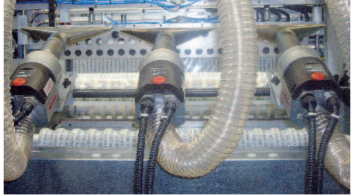
Drei LHS 61S Luftheritzer mit Breitschlitzdüse in einer Packstrasse.
