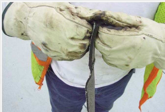
Der Schältest beweist, dass die Schweissnahtfestigkeit mit dem BITUMAT B2 eindeutig besser ist als mit offener Flamme.
