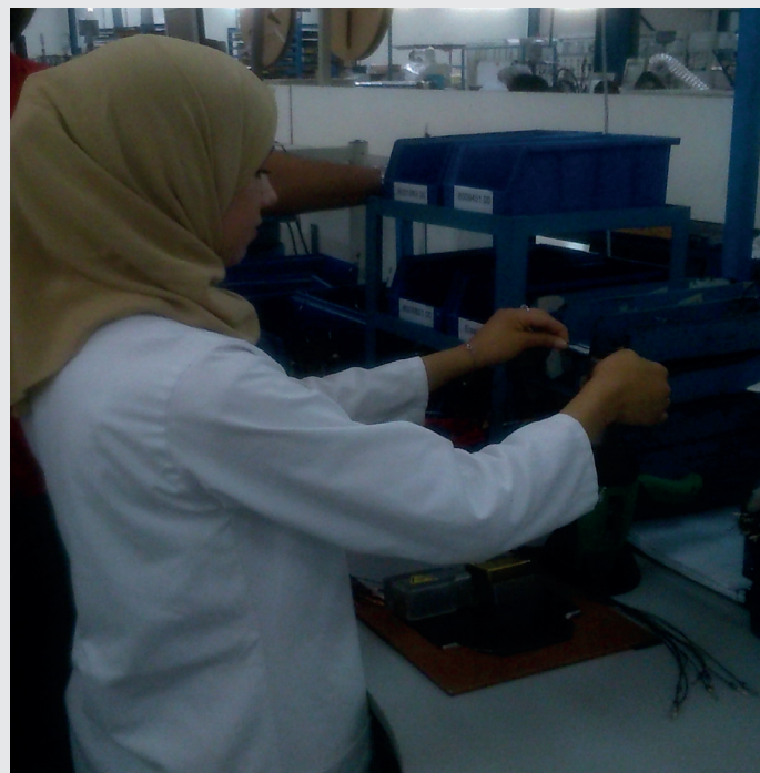
Ghibli AW pour opérations de rétraction, soudage, rétreint etc sur câble.
