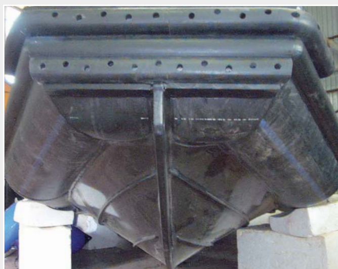
Face inférieure du bateau avec pièces soudées bord à bord et extrudées
