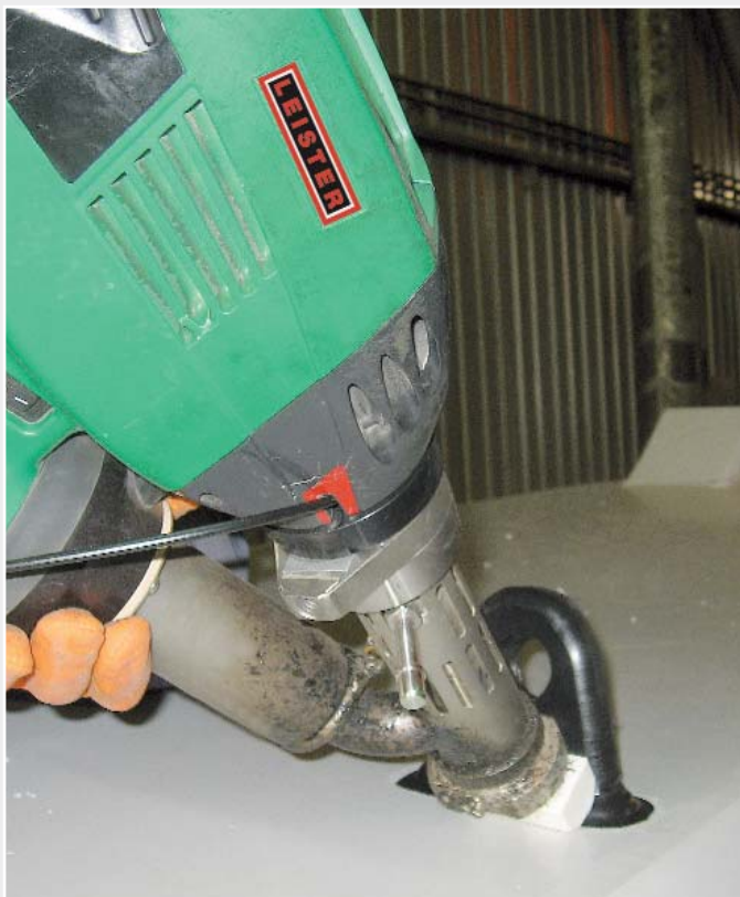
Extrusionadora manual en un trabajo detallado
