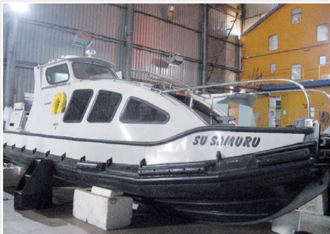
Botes de plástico de PE soldados para el transporte de pasajeros...
