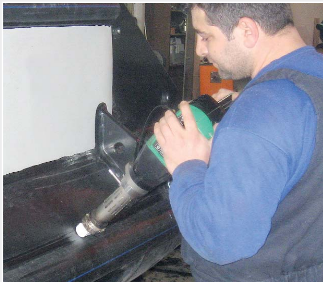
Extrusionar con la práctica WELDPLAST S2
