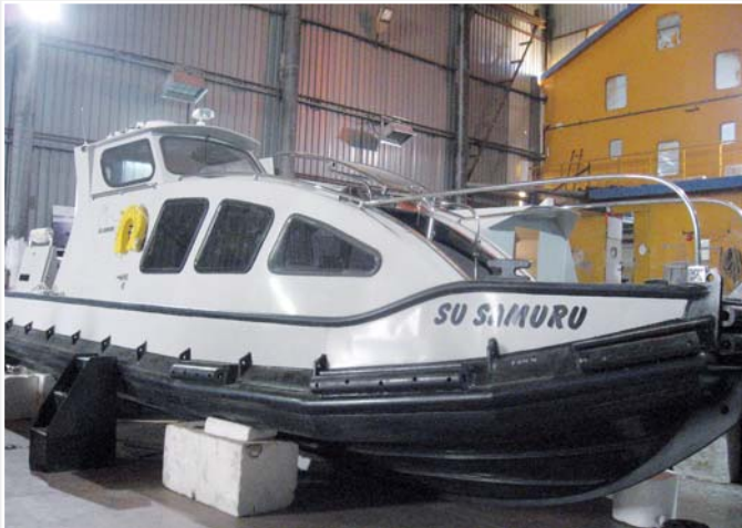
Fertige geschweisste Kunststoffboote aus PE für den Personentransport...
