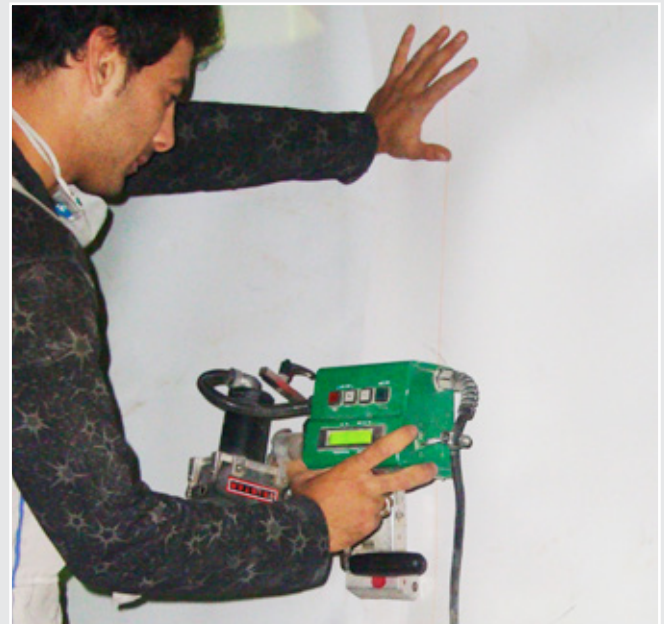
Das gut sichtbare Display liefert Daten zu Schweisstemperatur und -geschwindigkeit.
