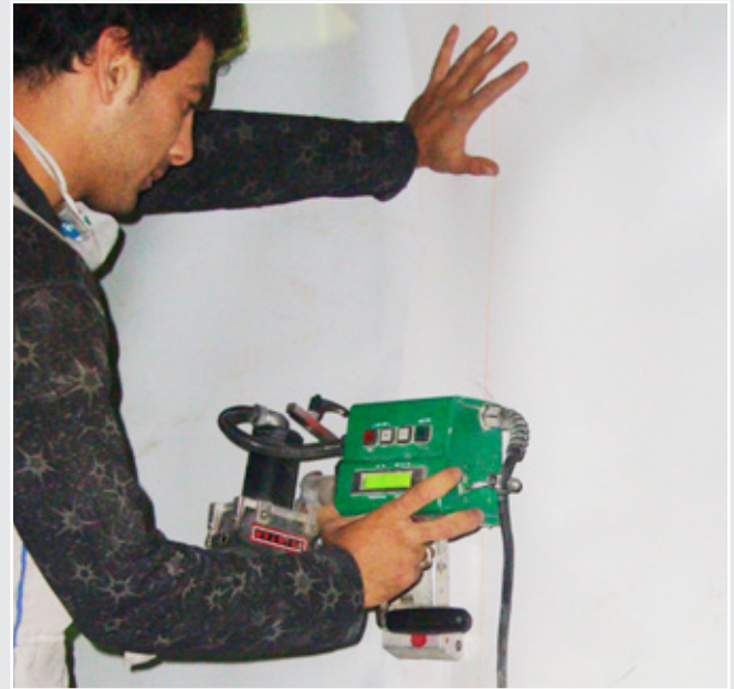
La pantalla permite una perfecta visualización de los datos sobre la temperatura y la velocidad de soldadura.
