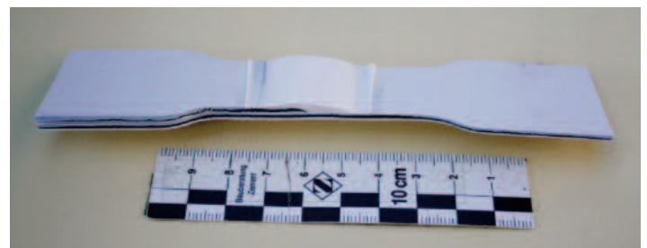
Bild 6: Schulterförmiger Probekörper mit mittiger Auftragnäht für Zeitstand-Zugversuche
