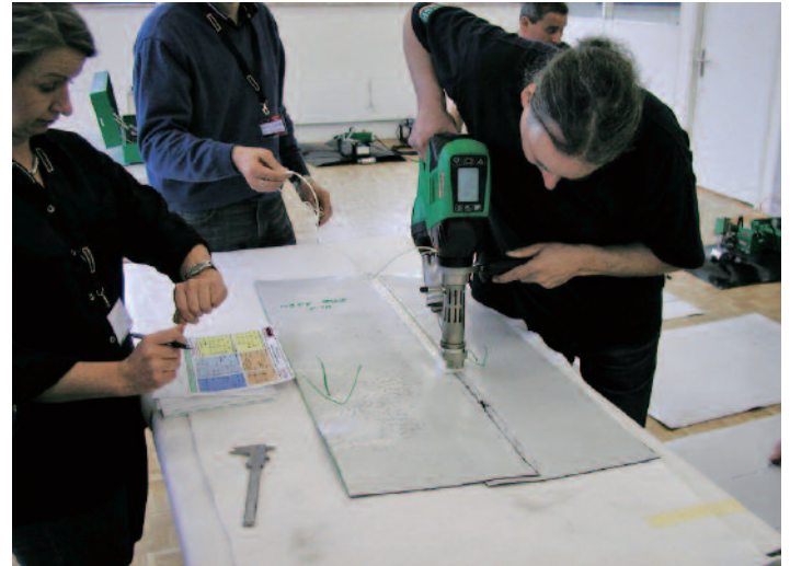
Bild 4: Warmgas-Extrusions-schweißen mit dem Hand-Extruder vom Typ „Leister Weldplast S2“
