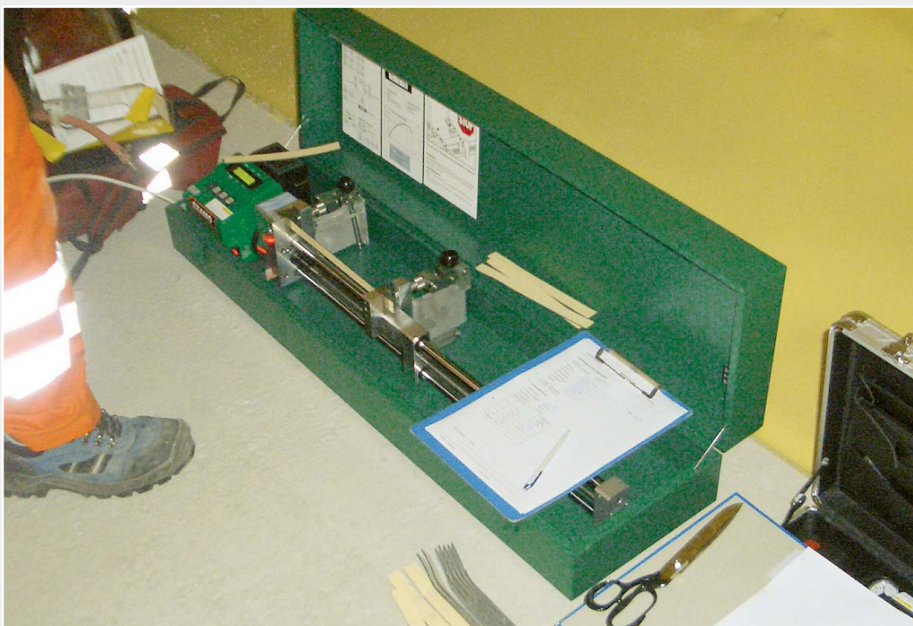
Les essais de pelage sont réalisés en laboratoire, mais également sur place avec l'appareil de contrôle EXAMO de Leister.
