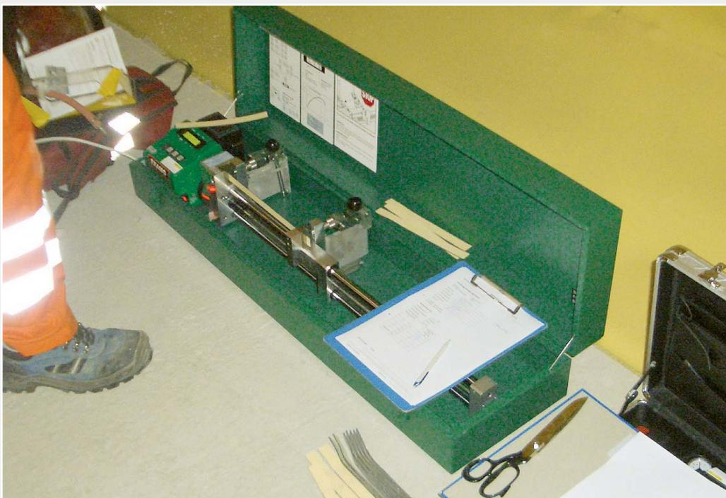
*Schältests werden im Labor, aber auch vor Ort mit dem Prüfgerät EXAMO von Leister durchgeführt.*
