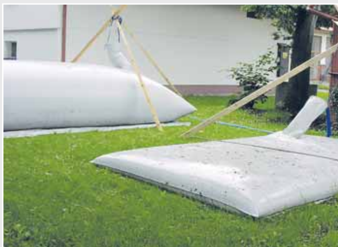
Las costuras de soldadura de depósitos para líquidos deben soportar las máximas presiones.
