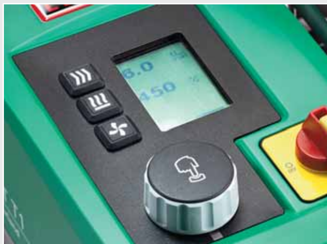
La nueva unidad de mando “e-Drive” para el control de los parámetros de soldadura.
