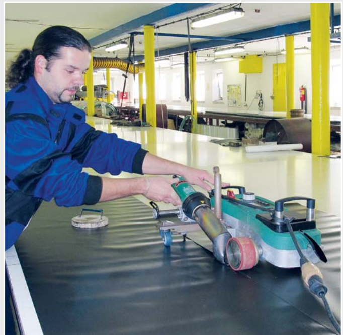
Einfache Führung des VARIANT T1 während dem Schweißprozess.
