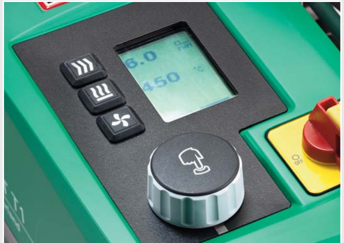
Die neue Bedieneinheit „e-Drive“ zur Kontrolle der Schweißparameter.
