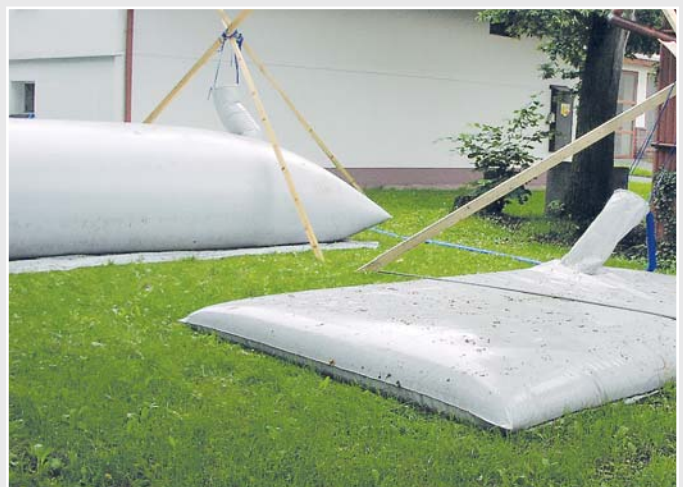
Schweißnähte von Aufbewahrungsbehältern für Flüssigkeiten (sog. „Flexitanks“) müssen hohem Druck standhalten.
