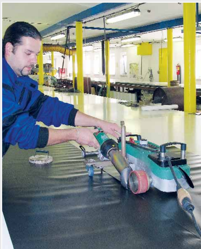
Jednoduché vedení VARIANTU T1 během svařování.
