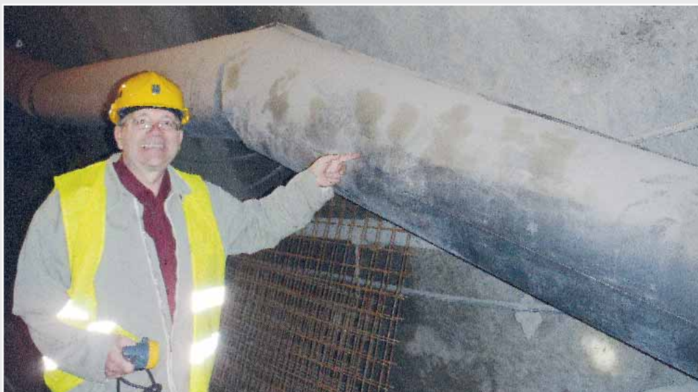
Majitel společnosti Jiří Žajdlík se vzduchovým kanálem Duflex v důlní štolě.
