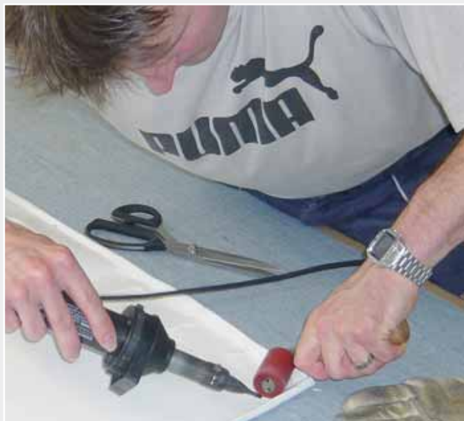
Le HOT JET S de Leister est l'aide manuelle idéale pour le soudage de détails.
