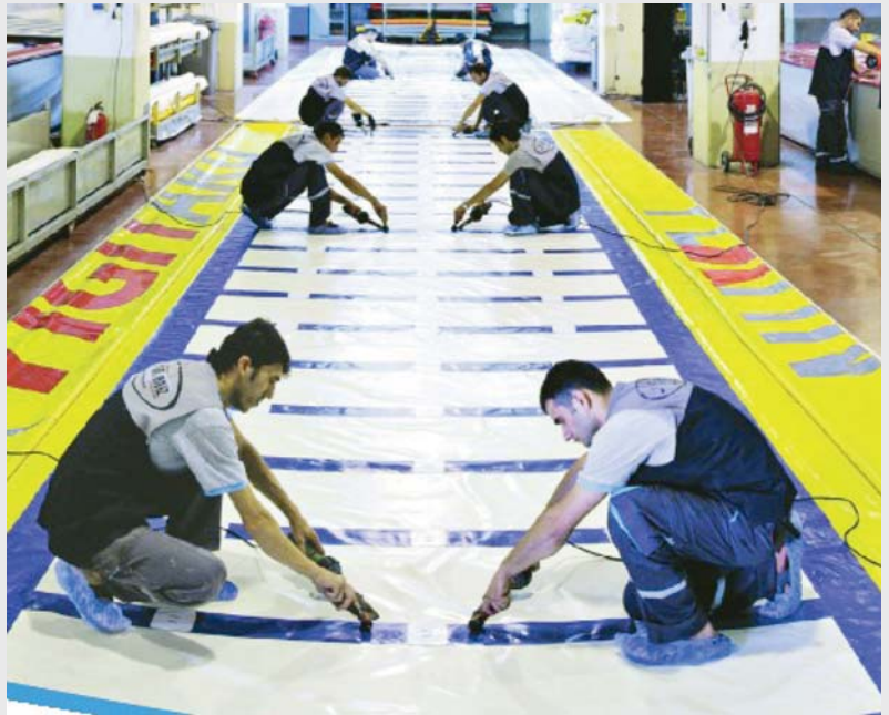
40 TRIAC S Handgeräte werden für Detailarbeiten eingesetzt.
