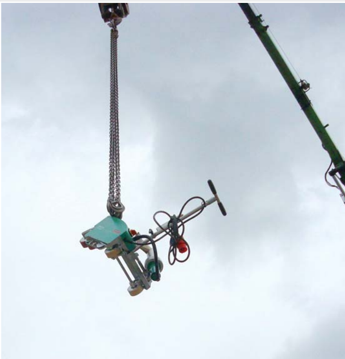
Con il gancio per la Gru può essere sollevato sul tetto anche senza box.
