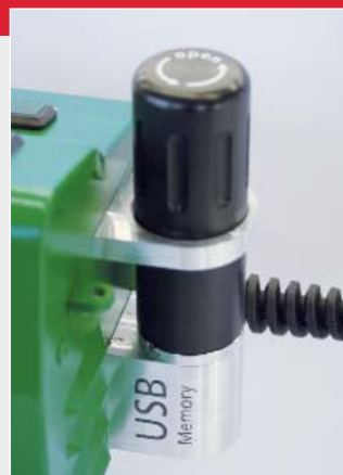
La clé USB est protégée et simple à retirer
