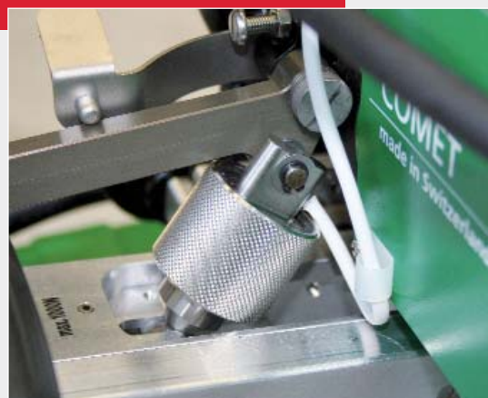
Mesure de la pression avec le COMET USB
